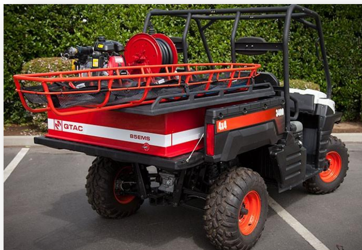
Рисунок 2. Модуль QTAC 85EMS в кузове багги
